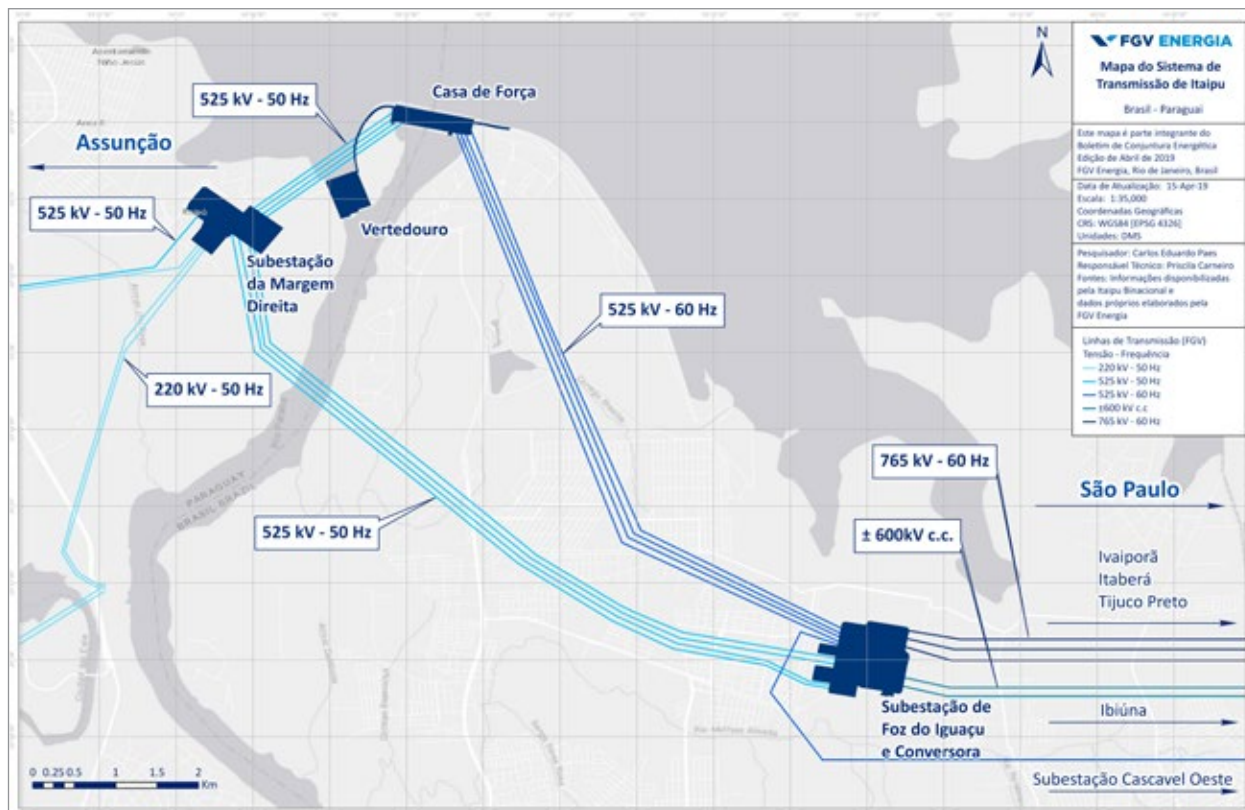
Figura 1 – Sistema de transmissão de Itaipu.
